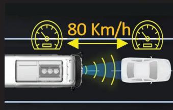
Hệ thống điều khiển hành trình
