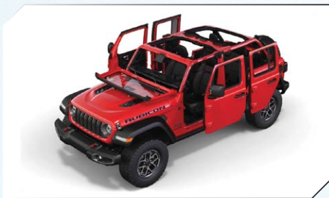
Cửa xe làm bằng vật liệu nhôm nhẹ, bản lề thiết kế tối ưu để tháo rời
